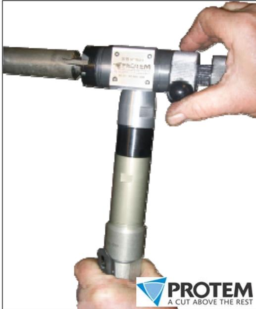
La herramienta portátil para biselado de tubos S18 es la máquina de biselado y refrentado más potente, robusta, fiable y versátil del mundo. La S18 trabaja con diámetros desde Ø 18 mm (interior) hasta Ø 42 mm (exterior).
